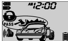
Отключена основная зона датчика
