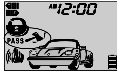
Отключена предупредительная зона датчика
