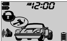
Срабатывание предупредительной зоны датчика
