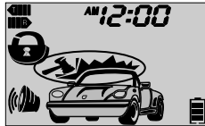
Срабатывание основной зоны датчика
