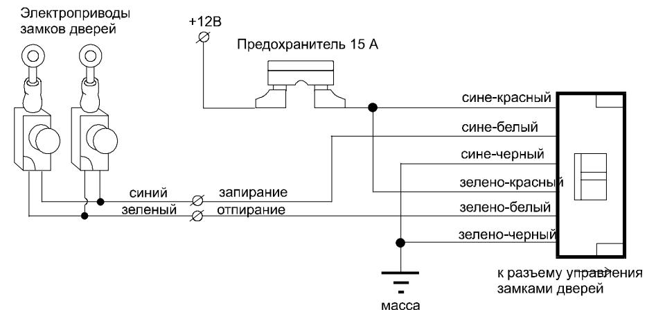
Ниже приведен наиболее часто встречающийся вариант подключения замков дверей с двух шаговым управлением
